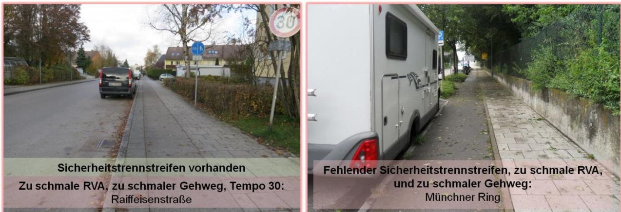
Abb. 22: Baulich angelegter Trennstreifen zum Ruhenden Verkehr (Bild links) und fehlender Trennstreifen (Bild rechts).
