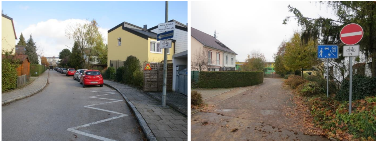
Abb. 34: Für den Radverkehr in Gegenrichtung freigebende Einbahnstraßen: Elisabethstraße (linkes Bild) Carl-Meut-Straße (rechtes Bild, unechte Einbahnstraße)
