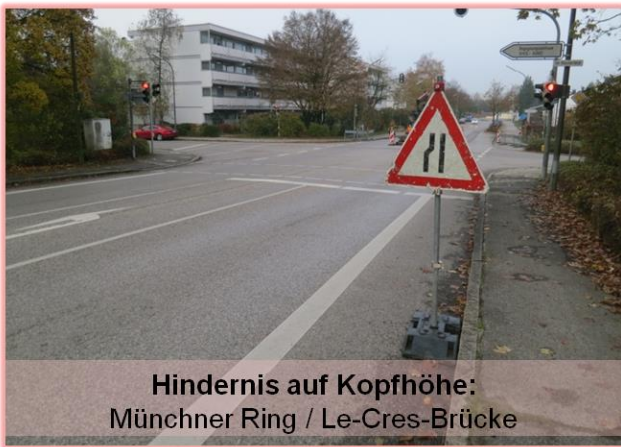
Abb. 24: Baustellenbeschilderung als Hindernis im Lichtraum (Bild links) und Umlaufsperrn bei schlechten/schwierigen Lichtverhältnissen (Bild rechts)
